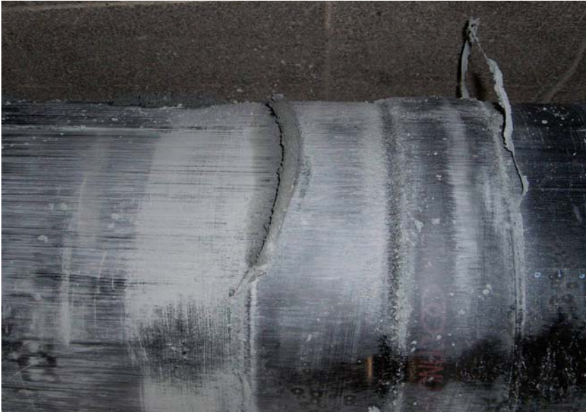
Bild 8: KMR 2355 nach Sandkastenprüfung: Lediglich in 6-Uhr Lage Druckseite ein geringes Lösen der Manschette.
