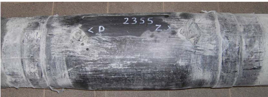
Bild 7: KMR 2355 nach Sandkastenprüfung: Keine Riefen im Mantelrohr (D = Druckseite, Z = Zugseite)
