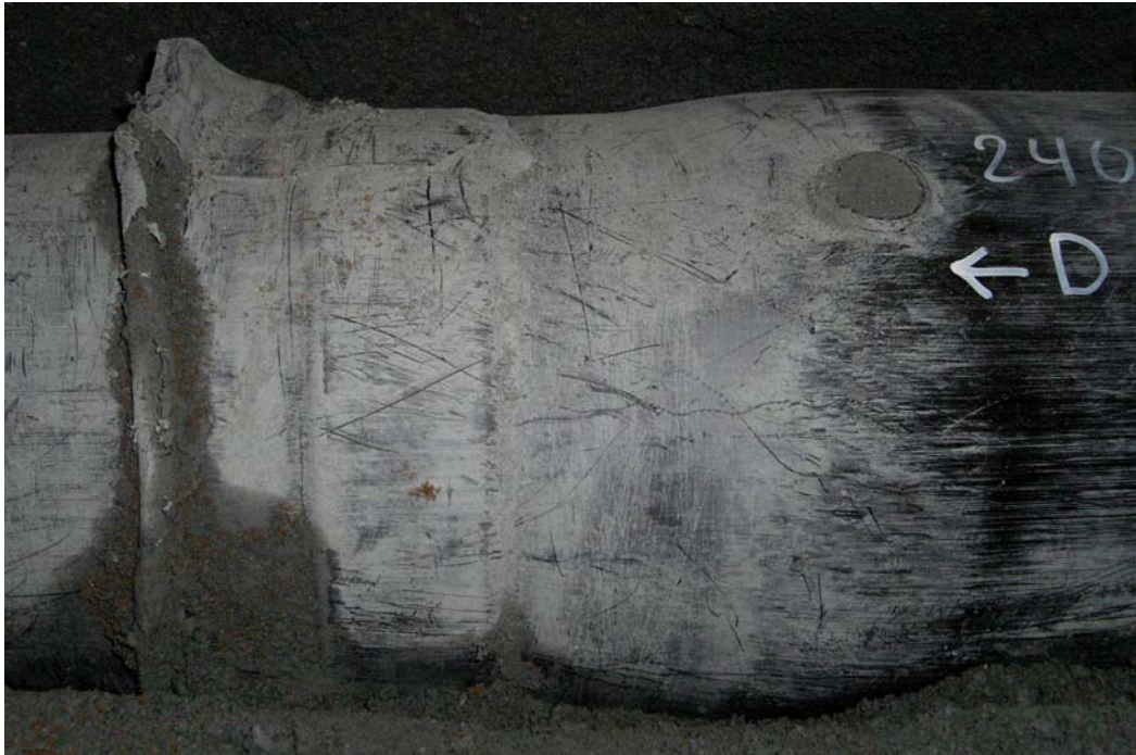
Bild 13: KMR 2401 nach Sandkastenprüfung, Druckseite: Keine Riefen im Mantelrohr
