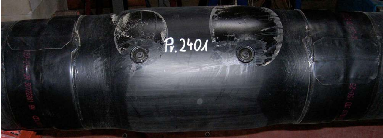
Bild 10: KMR 2401 im Anlieferungszustand Muffenbereich in 12-Uhrlage vor der Prüfung; Schäumlochstopfen ohne Patches
